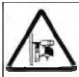
Никогда не включайте забивной пистолет со срабатыванием в свободное пространство. Таким образом Вы предотвратите возникновение опасности от свободно лежащих вбиваемых деталей, а также перегрузку пистолета. Никогда не пытайтесь устанавливать вбиваемую деталь на спинку или головку уже забитой детали.
