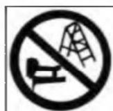
Вбивающие механизмы, которые оснащены контактным приводом или постоянным приводом с предохранительным устройством и обозначены символом
