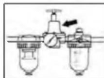
**Примечание:** При выработке сжатого воздуха компрессорами природная влажность воздуха конденсируется и собирается в качестве конденсата в напорных котлах и
