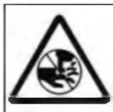
Держите забивной пистолет в работе так, чтобы голова и тело не могли получить травму в результате возможной отдачи. Руки и другие части тела должны при работе находиться вне зоны ствола, чтобы избежать травмирования.
