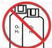
Инструмент предназначен для работы на сжатом воздухе. Не работайте с инструментом на любом другом газе высокого давления, горючих газах (например, кислороде, ацетилене и т.д.), так как существует опасность взрыва. Поэтому категорически запрещается использовать для работы с инструментом что-либо, кроме воздушного компрессора.
