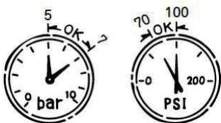
Инструмент рассчитан на работу в диапазоне давления воздуха от 70 до 100 фунтов на квадратный дюйм (5–7 бар). Давление должно быть отрегулировано в соответствии с типом крепежа. Инструмент нельзя использовать, если рабочее давление превышает 120 фунтов на кв. дюйм. (8,3 бар).
